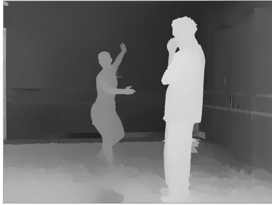
Figure 2.10: Le figure più chiare sono quelle più vicine al dispositivo, man mano che ci si allontana dal dispositivo gli oggetti rilevati assumono un colore più scuro.
