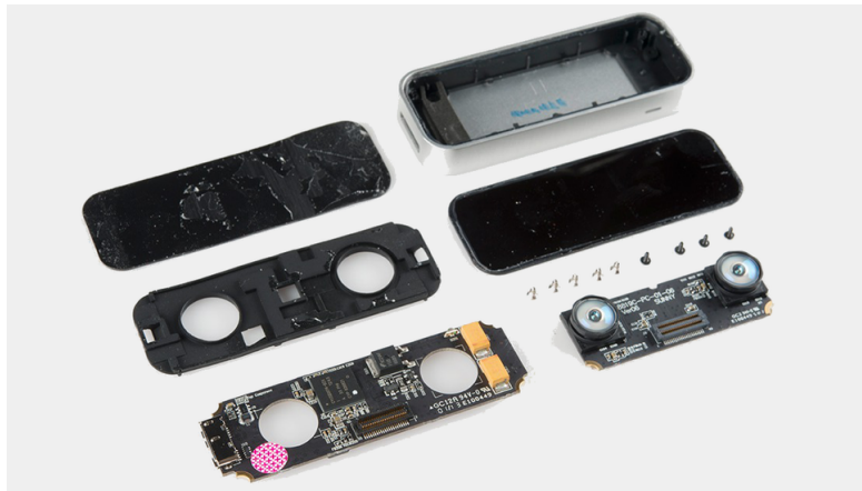
Figure 2.21: Una visuale di tutte le componenti del leap motion
