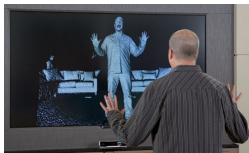
Figure 2.9: Le figure più chiare sono quelle più vicine al dispositivo, man mano che ci si allontana dal dispositivo gli oggetti rilevati assumono un colore più scuro.
